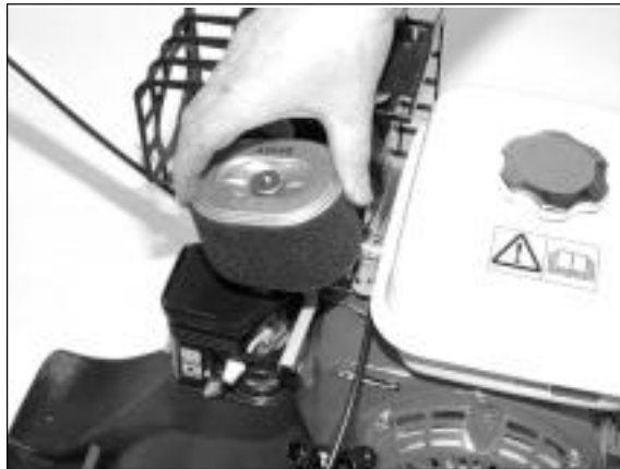
4) Wyjmij wkład filtra.
