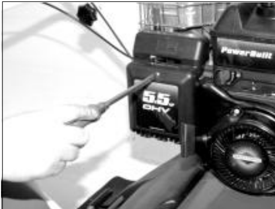
1) Wykr rub mocuj c pokryw filtra powietrza.
