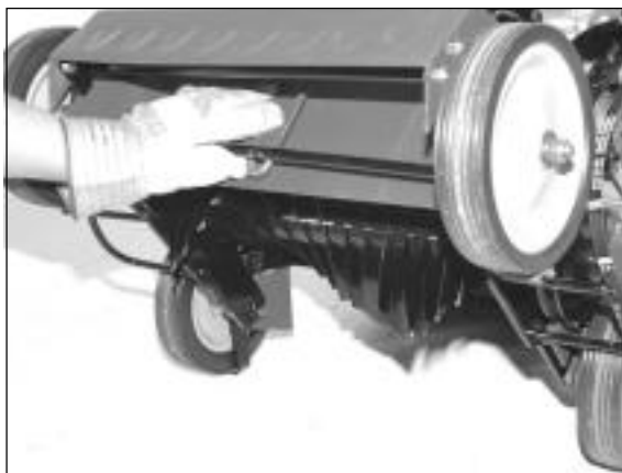
3) Wał wymienny podnieś i zawieś na haku.
