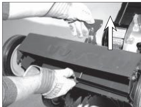
4) Podnie wertykulator i poło na ramionach kierowicy.
