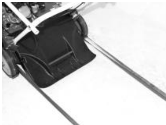
2) Transport wertykulatora na aucie: przymocuj maszynę pasami napinającymi za przednią i tylną część.
