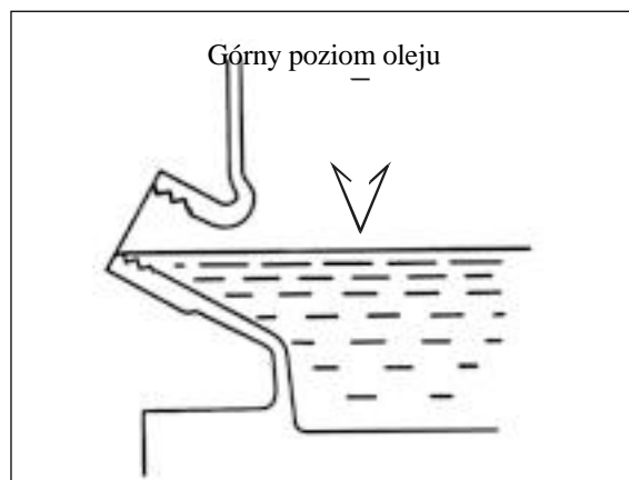
Korek wlewu oleju w silniku Honda Kawasaki-Motor.
