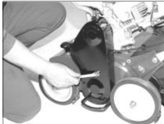
4) Teraz zamknij rygiel, tak aby ryglowanie wału z nozami było pewne.
