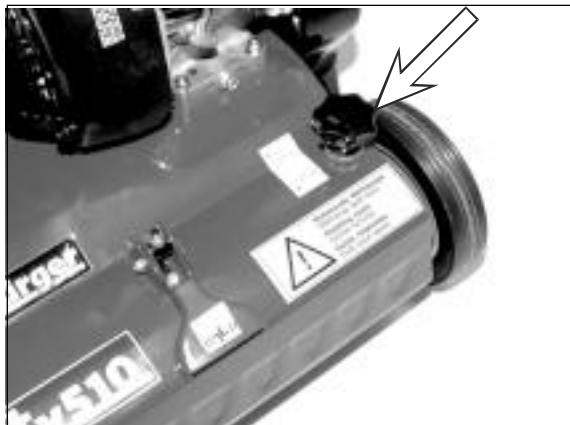
1) Pokrętło regulacyjne głośności pracy noży.
