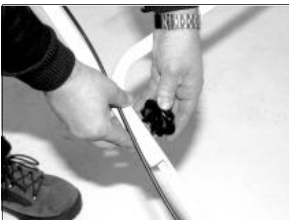
1) Poluzuj po obu stronach pokr tła mocuj ce górny kabł k ramion kierownicy.
