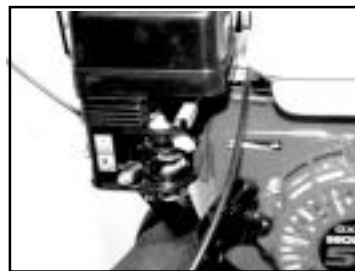
3) Kurek paliwa zamknięty.
