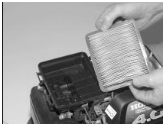
4) Lamelki wyczy ostro nie stukaj c lub spr on. powietrzem.
