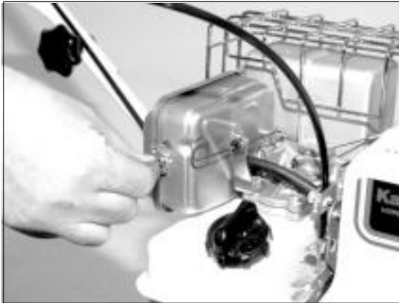
1) Poluzuj rub pokrywy filtra powietrza.
