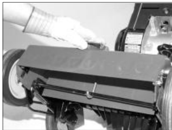
4) Teraz zamknij rygiel, tak aby ryglowanie wału z nozami było pewne.
