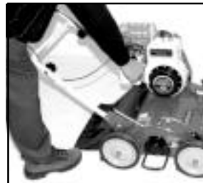
4) Poci gnij link stanowczo startera. Bacz, aby przy tym Nie znajdował się w strefie zagrożenia!...
