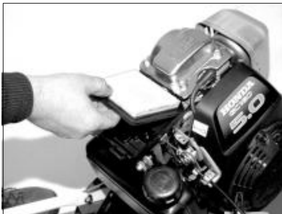
3) Wyjmij wkład filtra .
