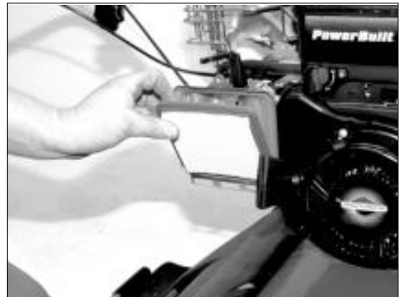
4) Lamelki wyczy ostro nie stukaj c lub spr onym powietrzem.
