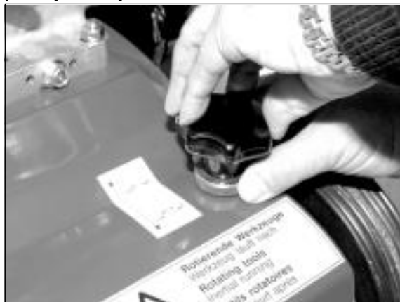
5) Dokręcając przeciwnakrętkę unieruchamiamy pokrętło.
