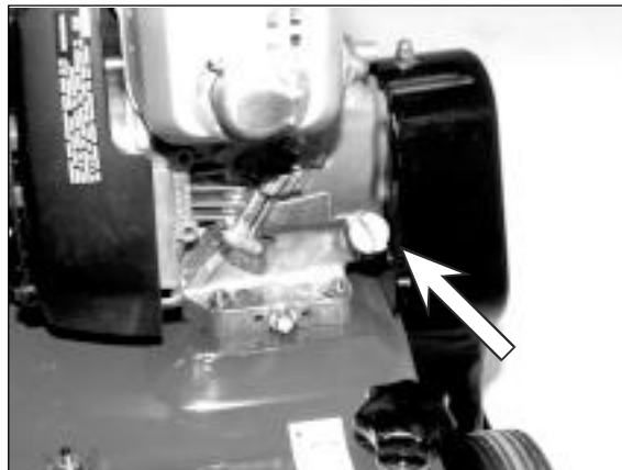
Korek wlewu oleju w silniku Honda GCV.
