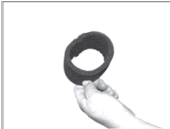
6) Ostrożnie wystukać filtr cząstek stałych lub oczyścić sprężonym powietrzem.
