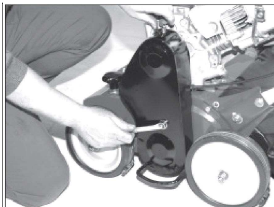
8) Pod koniec nałożyć i przykręcić osłonę paska klinowego.
