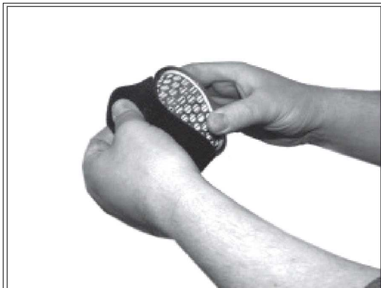
5) Ostrożnie wyjąć filtr cząstek stałych i oczyścić lamelki. Kawasaki
