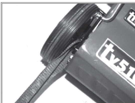
5) Poprowadzenie paska mocującego z przodu. Na wszelki wypadek należy wykorzystać oba punkty mocujące.
